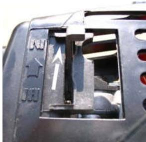
3. Проверьте положение воздушной заслонки (закрыто).
